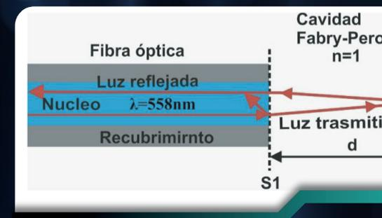
Figura 1: Diagrama de la interacción de la luz entre la punta de una fibra óptica monomodo y la cara de un espejo plano.
